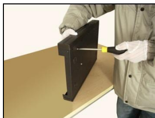
4. закрутите винты жесткого диска
