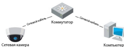
Рисунок 3-2 Соединение через коммутатор или роутер
