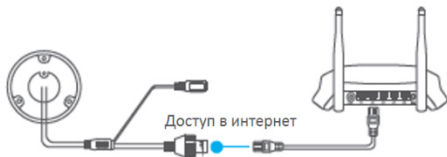
Рисунок 5-3 Подключение к роутеру
