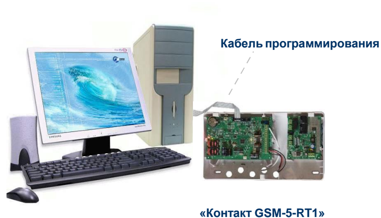
Рис.5.1. Подключение «Контакта GSM-5-RT1» к компьютеру через кабель программирования.
