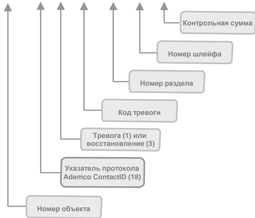
Рис.6.1. Значение цифр сообщения в протоколе Ademco ContactID.
